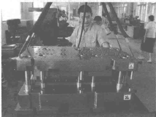
图1-7 安装冲压模具
