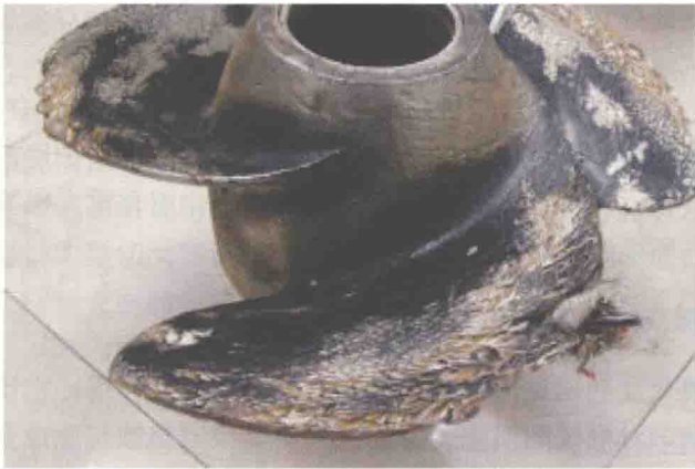
图 1-2 水轮机叶片冲蚀磨损
