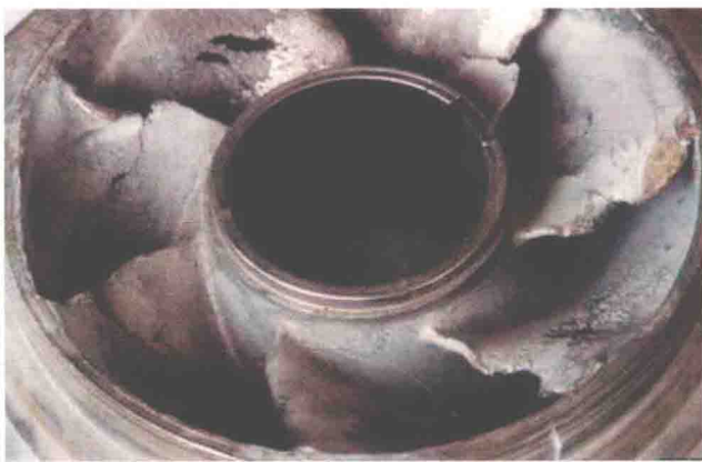
图 1-3 水轮机叶片的空蚀磨损
