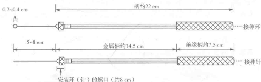
图 2-1 接种环和接种针的结构示意
