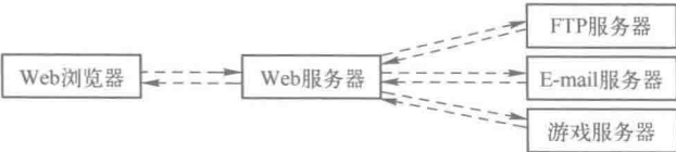
图 1-4 基于 B/S 模式的网络服务系统的结构
