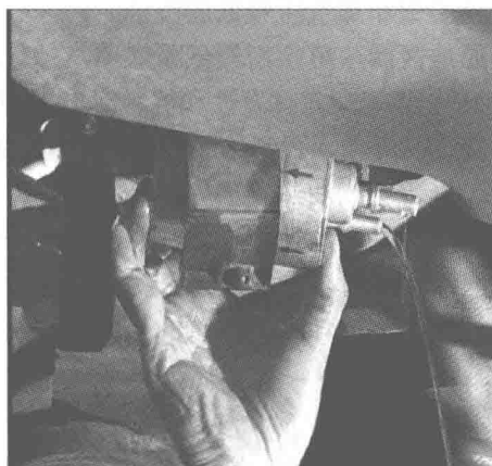
图 1-6 将燃油滤清器和输油管路断开
