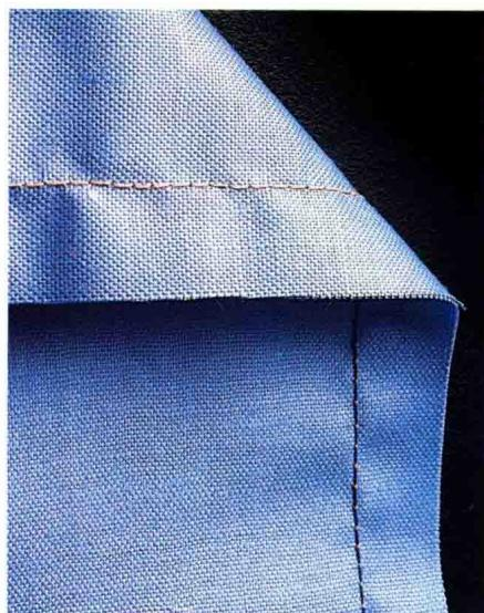
**张力太大，使底线和面线在靠近上织物层处相扣，织物起皱，针迹易断。请将张力度盘调至较小的数位。如果压力太大，下织物层会皱起，还可能被弄坏。针迹的长度和松紧度都可能不均匀。请将压力调节器调至较小的数位。**
