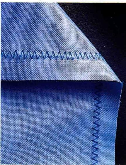
**适度的张力和压力使之字形针迹的底线和面线连锁相扣处恰好位于每一个针迹的角上和上、下层织物的中间。针迹平整，织物不起皱。**
