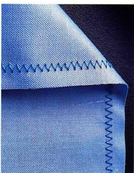
**张力太小会使下织物层起皱；底、面线相扣处会偏向下织物层。请加大张力平衡针迹。在通常缝制过程中，应适度平衡之字形针迹。要缝装饰性针迹，稍微减小张力，那末表层针迹就变得更丰满。**
