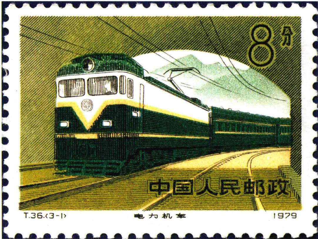
这枚中国邮票上的火车头，是韶山 1 型电力机车，1958 年中国株洲电力机车厂和湘潭电机厂联合研制，长度 19400 毫米，车轴排列形式 C<sub>0</sub>-C<sub>0</sub>，车轮直径 1250 毫米，重量 138 吨，最高速度每小时 90 公里。此型机车是中国第一代干线客货两用电力机车，因其电机是毛泽东主席故乡湖南湘潭制造的，所以命名为韶山型。现存两台，中国铁道博物馆和沈阳铁路陈列馆各陈列一台。
