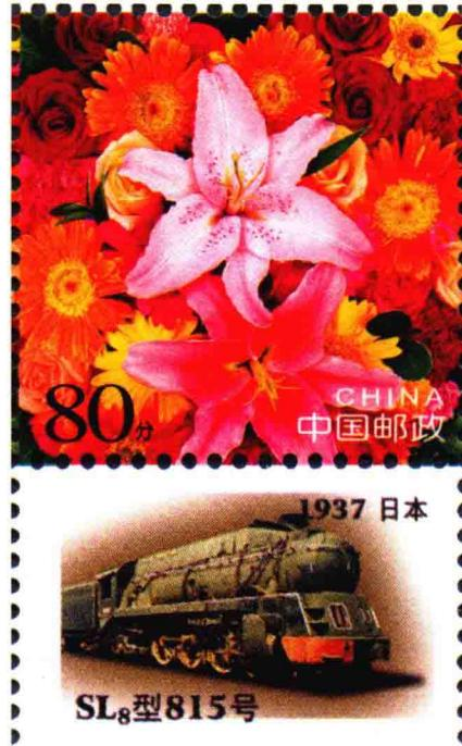
这枚中国邮票上的火车头，是太平洋 8 型 815 号蒸汽机车，1937 年日本日立制作所制造，日本人称其为 パシハ，长度 24705 毫米，车轴排列形式 2-3-1，动轮直径 1850 毫米，机车重量 114.91 吨，最高速度每小时 120 公里。这台机车是当时的高速机车之一，曾牵引过“满铁”著名特快客车“亚细亚号”，现保存于沈阳铁路陈列馆（未展出）。
