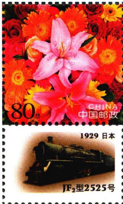
这枚中国邮票上的火车头，是解放 2 型 2525 号蒸汽机车，原称ミカニ型，中文译名天皇式，1929 年日本川崎公司造船厂授权制造，长度 22340 毫米，车轴排列形式 1-4-1，动轮直径 1370 毫米，机车重量 178.8 吨，最高速度每小时 80 公里。它有 3 个气缸，牵引力大，适合牵引长大坡道上的重载货物列车，现陈列于沈阳铁路陈列馆。
