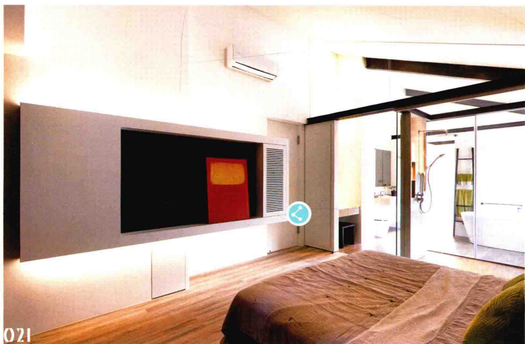
021 施工细节。机柜以百叶形式规划，既能散热又能接收遥控联结。
