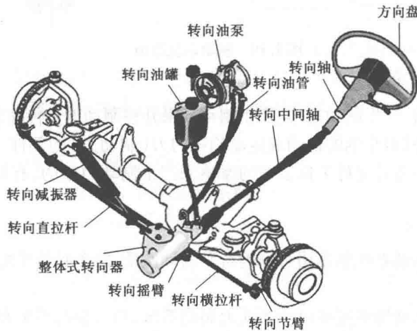
图 1.9 转向系统结构
