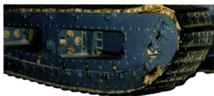
车体两旁的履带都是由铸钢履带板链接而成的
