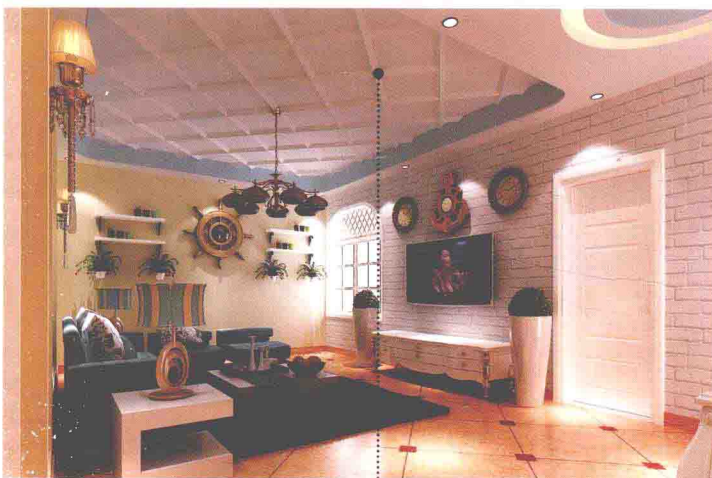
白松木格栅吊顶
