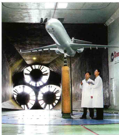
图 1-7 ARJ21 新支线客机金属像真模型 在 8 m×6 m 风洞内做试验
