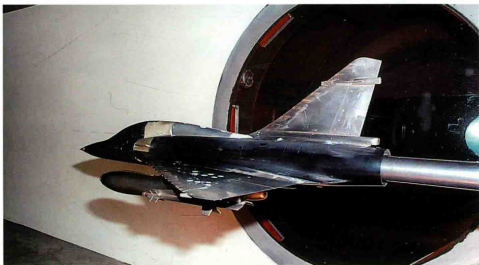
图 1-9 欧洲某战斗机全金属实体模型在风洞中进行科研试验
