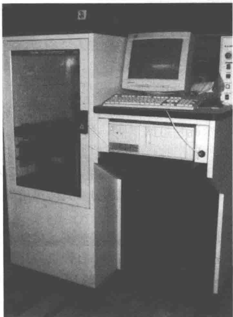
图 1-3 第一台 3D 打印机 SLA-25D
