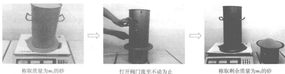
图 1-1-10 确定标定罐内砂的质量步骤
