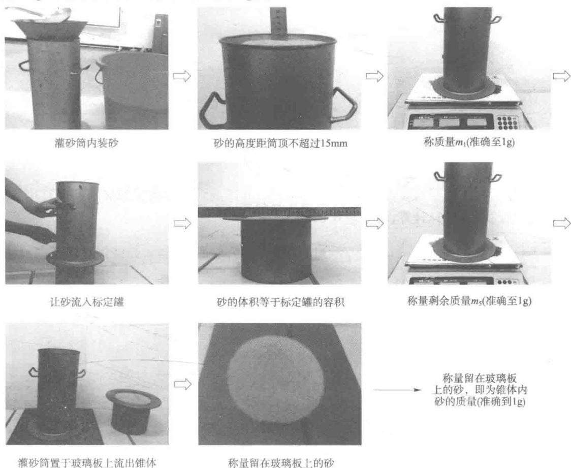
图 1-1-9 确定灌砂筒下部圆锥内砂的质量的步骤
