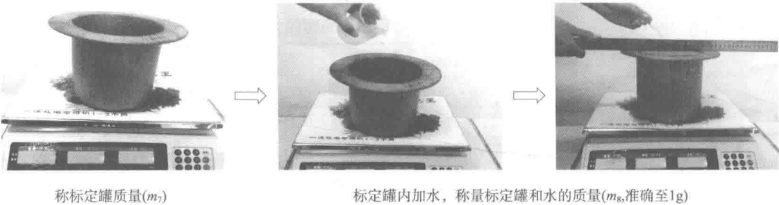
图 1-1-11 确定标定罐容积的步骤
