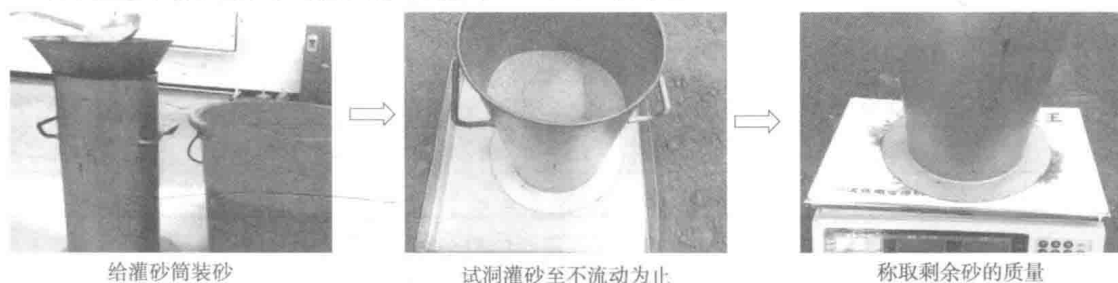
图 1-1-14 试洞内装砂、灌砂的步骤
