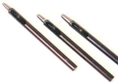
打孔冲子（圆冲） 钻缝线孔或安装铆钉时使用。从左至右分别为1.5毫米、2.0毫米、2.5毫米。
