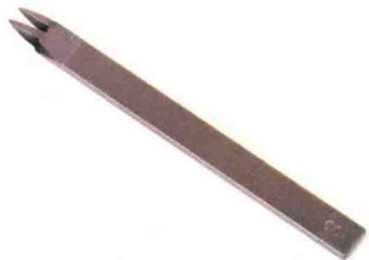
菱錐 钻缝线孔时使用的工具，间隔3毫米，齿的数量有从一到十的种类。
