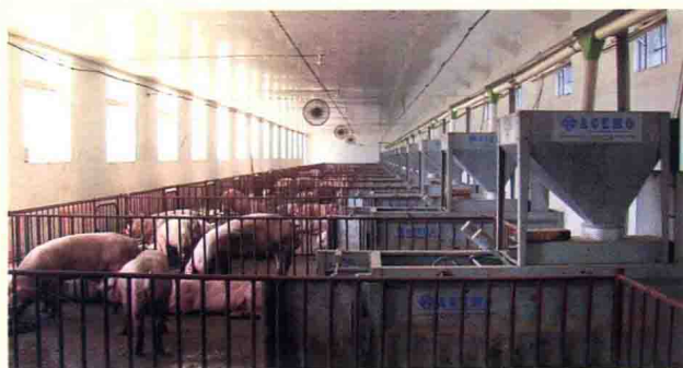
彩图3 测定站采用ACEMA64种猪自动饲喂性能测定系统集中测定
