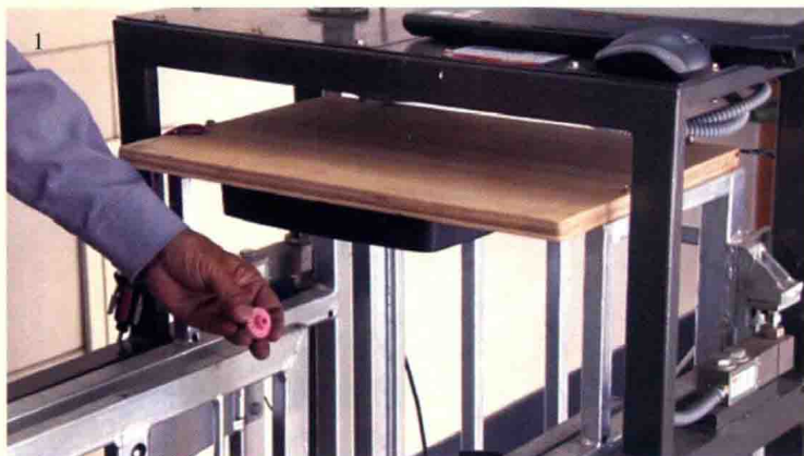
彩图6 检测装置读取猪只电子耳标信息
