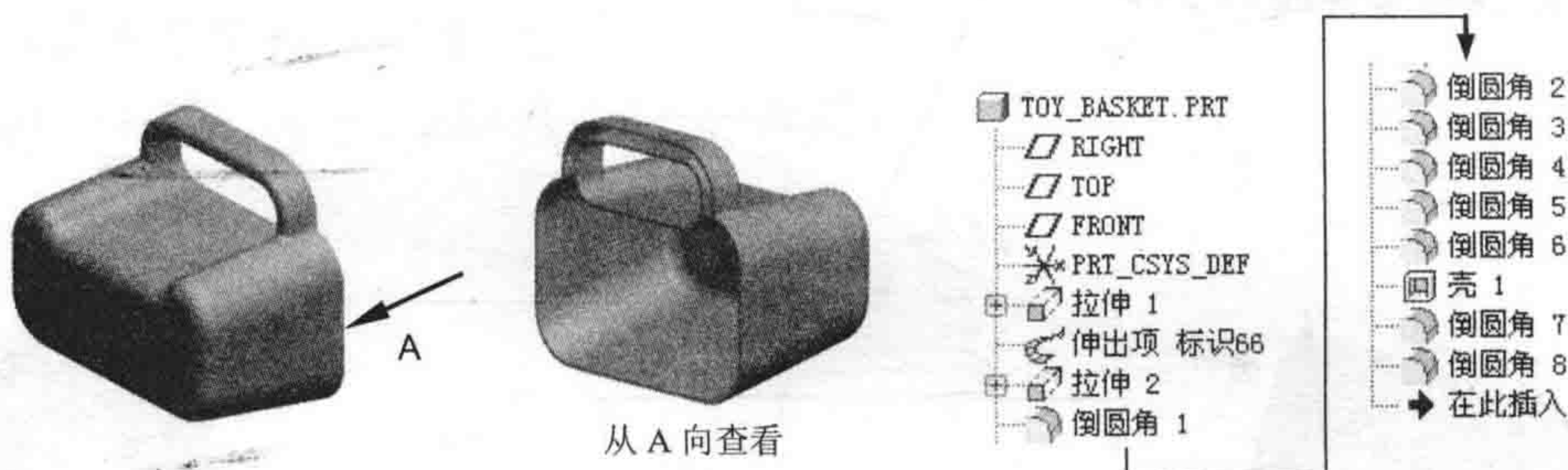
图 2.1 零件模型及模型树
