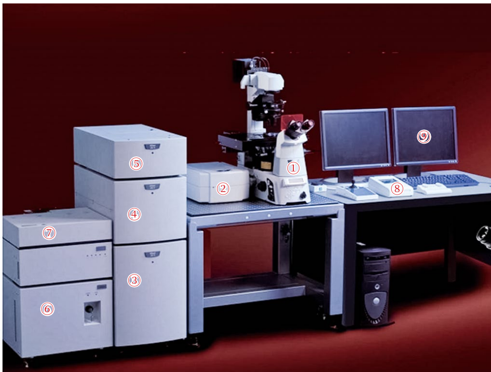
(注：①电动倒置荧光显微镜；②共聚焦显微镜扫描头；③共聚焦显微镜总控制器；④光谱探测模块；⑤检测器；⑥电源开关；⑦激光器开关；⑧遥控操作系统；⑨共聚焦显微镜工作站 + 检测器)
