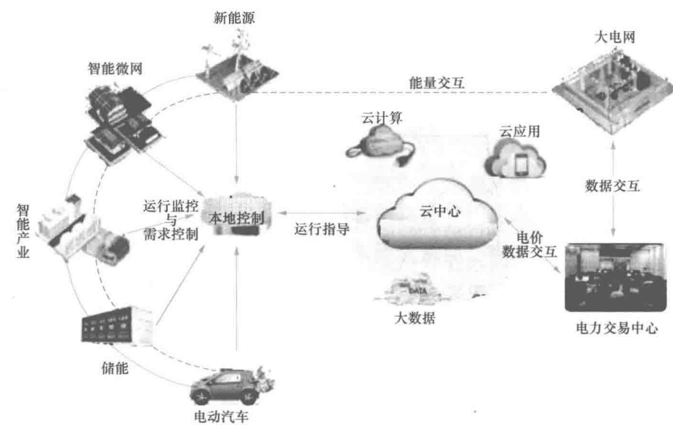
图 1-1 能源互联网环境下的电力体系架构
