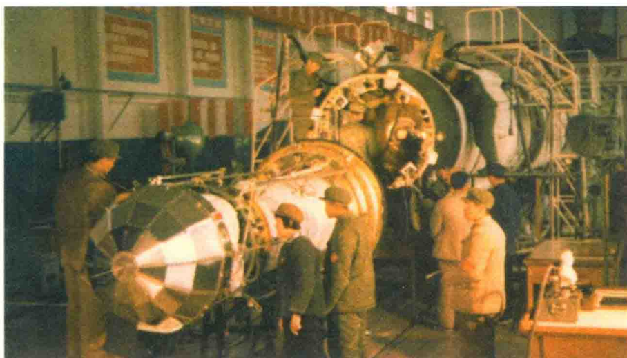
► DFH – 1 được kết nối với tầng trên của tên lửa
