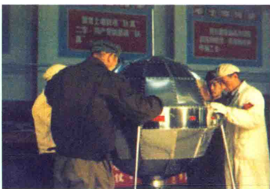
► Vệ tinh được lắp ráp vào tầng trên của tên lửa
