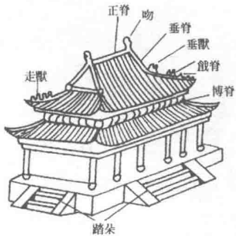
图 3 歇山顶基本构造
