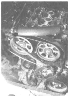
图 1-2 拆掉正时皮带罩
