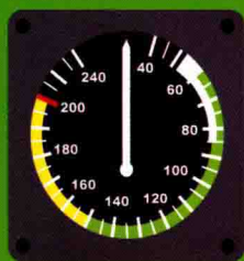
风速表显示飞机相对于空气的速度。
