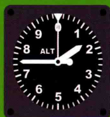
高度表确定海拔高度（离海平面的高度）。
