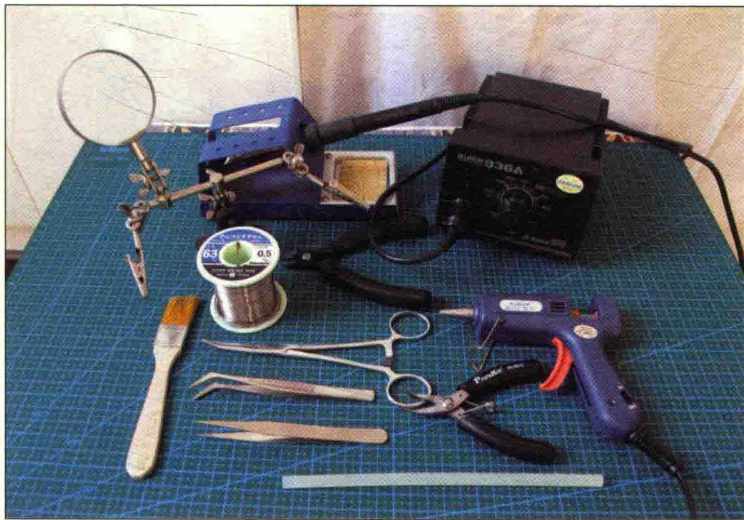
图1-15 制作机器人电子部分经常用到的工具
