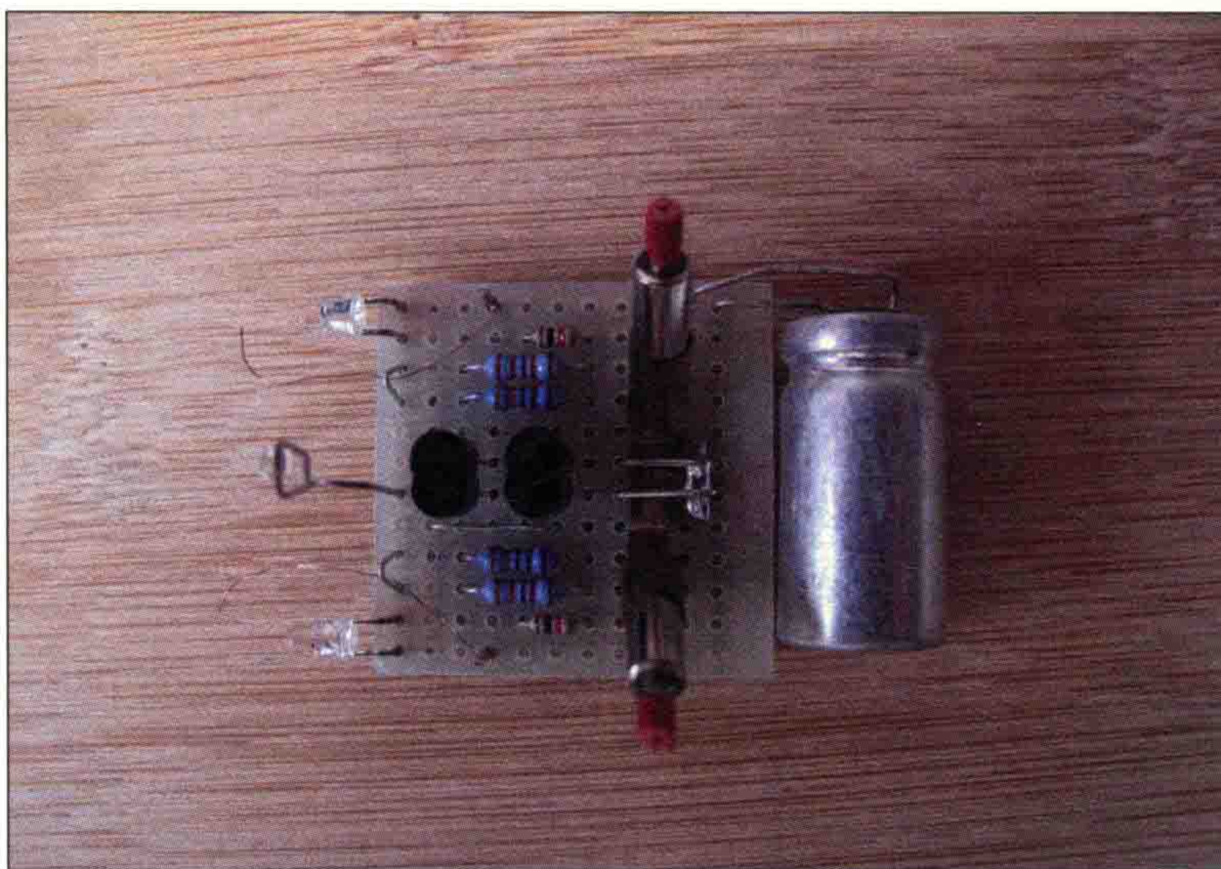
图 1-4 洞洞板蟋蟀的底部，各种细小电子元器件、电机和储能电容都固定在一片洞洞板上，构成了机器人的主体
