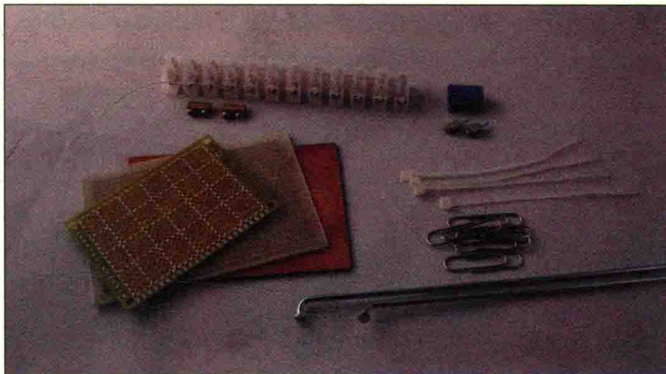
图1-10 机器人的结构材料：3mm 接线端子、洞洞板、尼龙扎带、曲别针、车条
