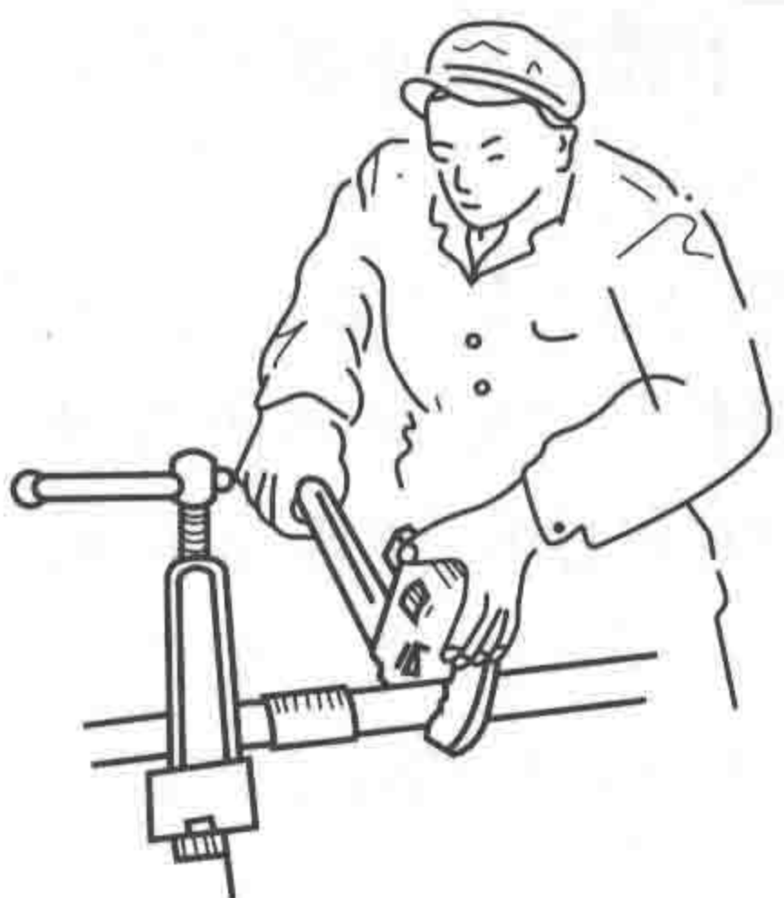
图 1-2 用管子钳做管子螺纹连接
