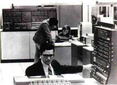
图 1-5 IBM S/370 引入了虚拟存储器的概念，图为 IBM S/370 195 型计算机。
