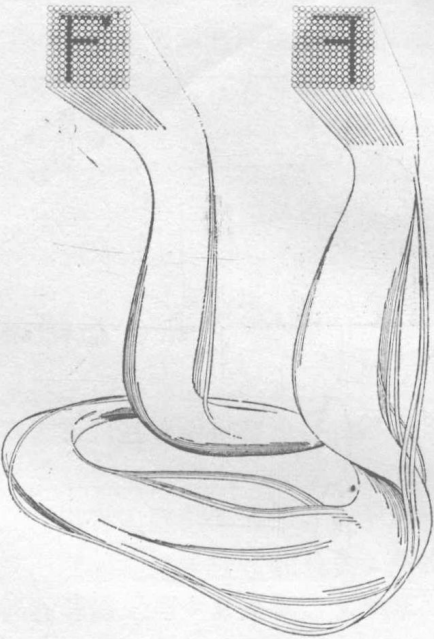
图12 纤维光束导象的示意图
