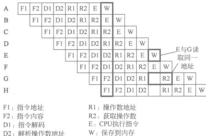
图 1-2 TI F28335 系列 DSP 的 8 级流水线
