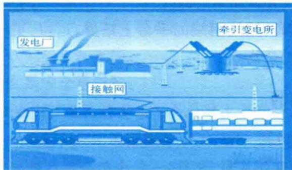
组成的闭合回路,当人为操作闭合或断开牵引供电回路时,在电磁能量相互转换的过渡过程中会形成瞬间的高电压,电压最高可达 90 kV,处理不当会造成严重后果。
