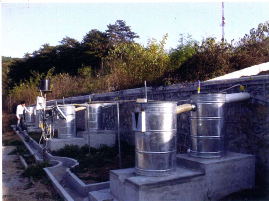
中国科学院陆地水循环及地表过程重点实验室崇陵流域 实验基地水土流失泥沙全自动在线监测装置
