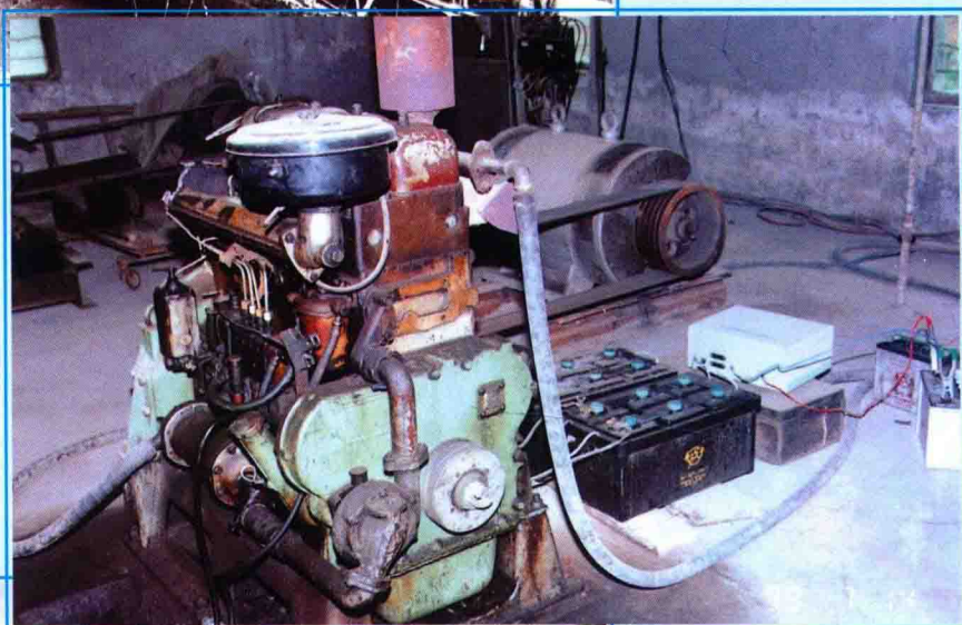
● 1954年枣阳熊河水 库工地照明用的12千瓦柴 油发电机组
