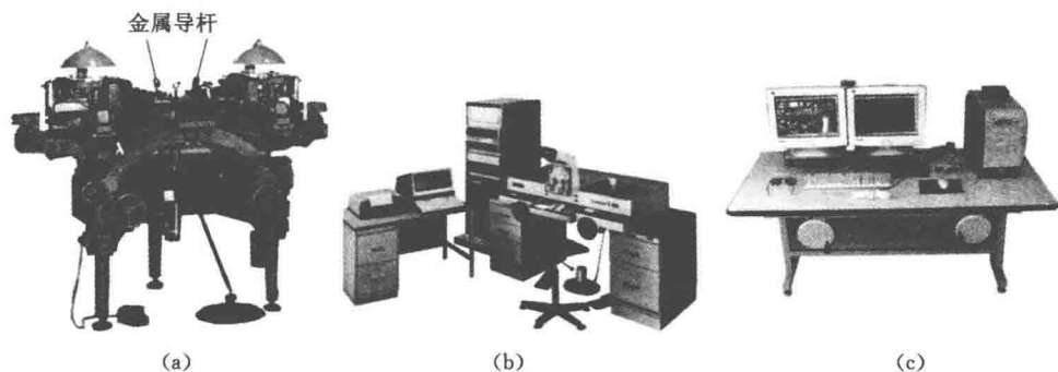
图 2-1 摄影测量发展的三种典型仪器 (a) 模拟测图仪 A8;(b) 解析测图仪;(c) 数字摄影测量工作站
