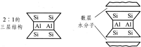
图 1.8 蒙脱石结构图
