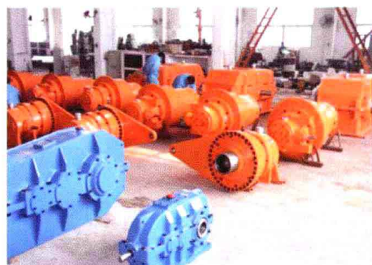
本厂专利产品2K-H悬浮均载行星齿轮减速器系列产品
