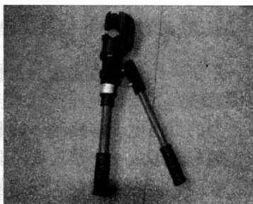
(b) C形连接器在贯通地线上的使用方式及压接钳
