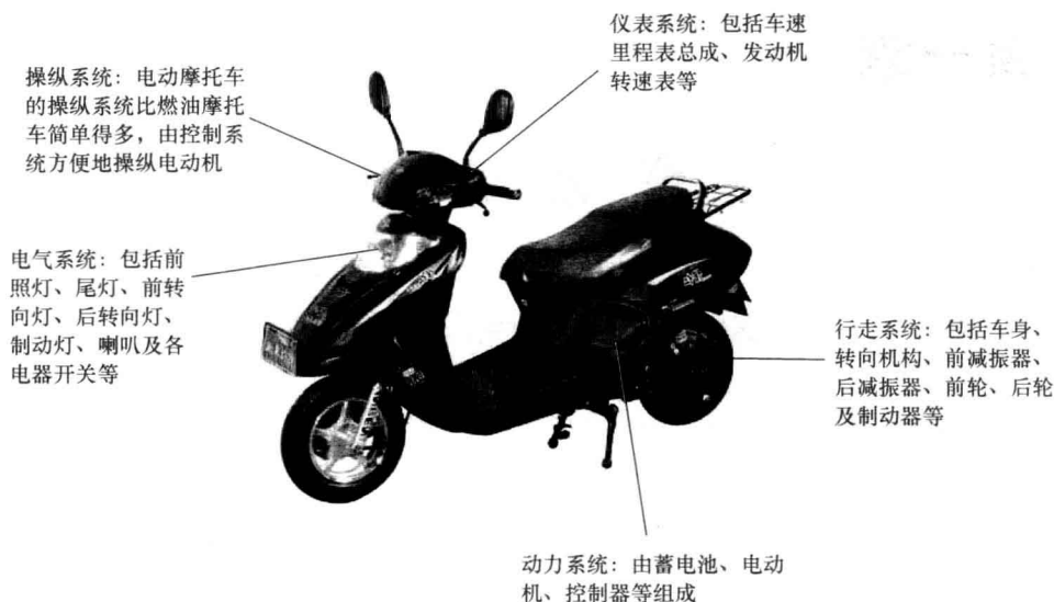
图 1-2 电动摩托车的基本组成
