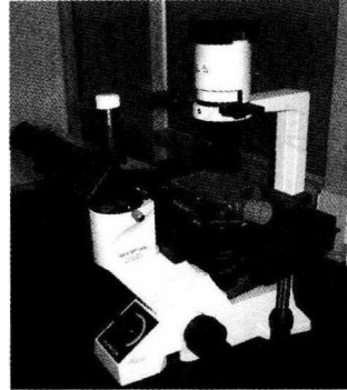
图 1-3 倒置显微镜(Olympus CK40 型)
