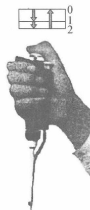
图 1-3 放液操作示意图
