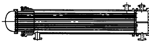
图 2-10 填料函式列管换热器
