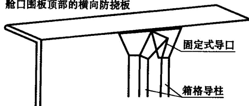
图 1-7 导箱轨顶端的喇叭口形导槽
