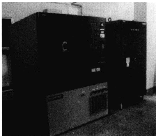
图 1-1 脉冲电流烧结 (SPS-1050) 装置外观图
