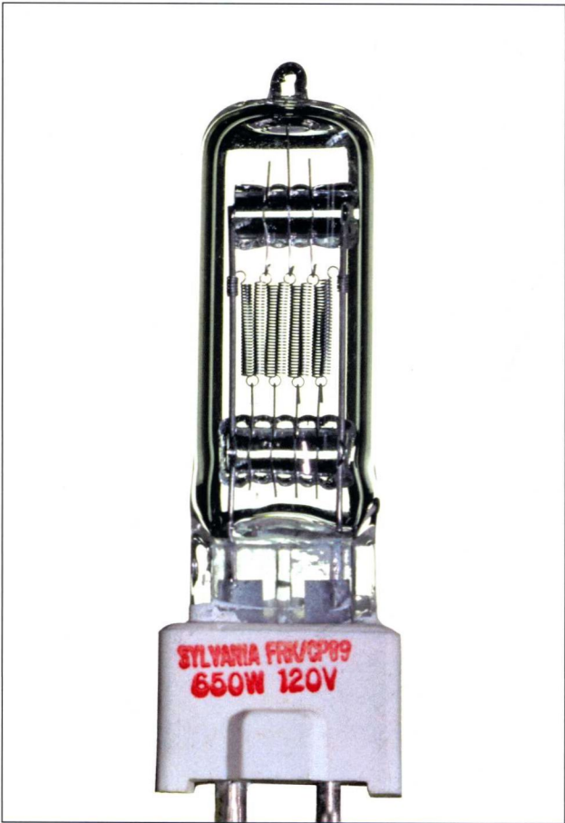
一只小型钨丝－卤素灯泡可以产生大量的光和更高的热量。因为有大 大约90%的光谱辐射是在红外线区域，所以你可以理解为什么称 它为“暖光灯”
