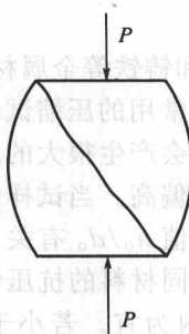
图 2-4 压缩时铸铁破坏断口
