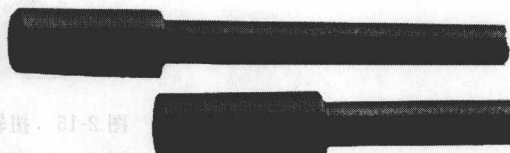
图 2-13 铸铁试件拉伸实验断口形式
