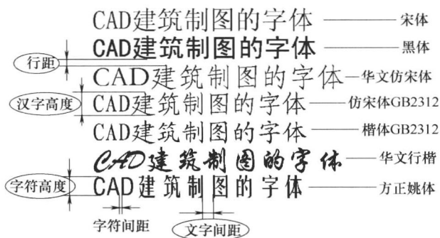
图 1.11 建筑结构 CAD 制图字体间距
