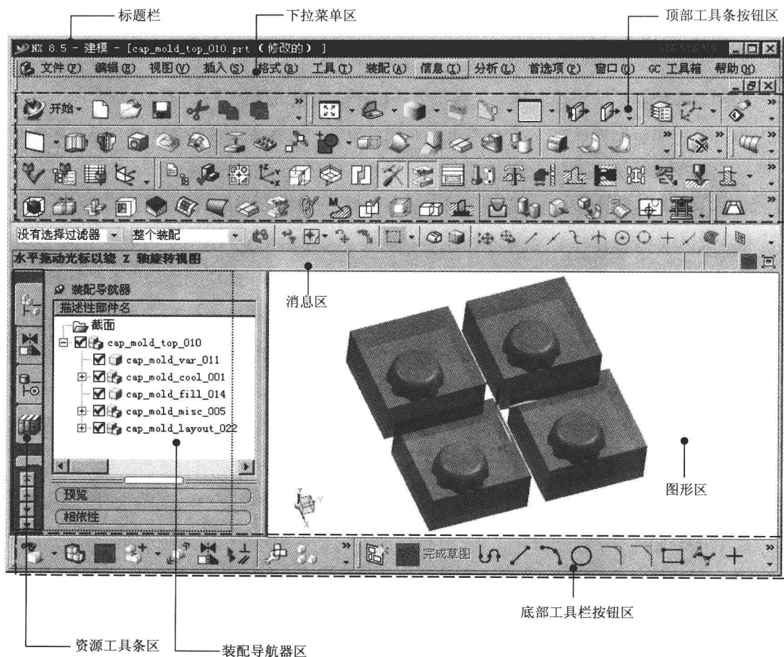
图 1.3.1 UG NX 8.5/Mold Wizard 模具设计工作界面
