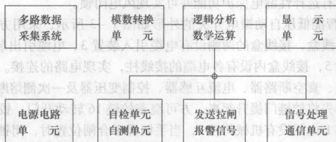
图 1-2 保护器基本工作原理示意图
