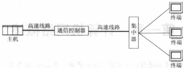
图 1.1.3 使用前端处理机和集中器的通信系统
