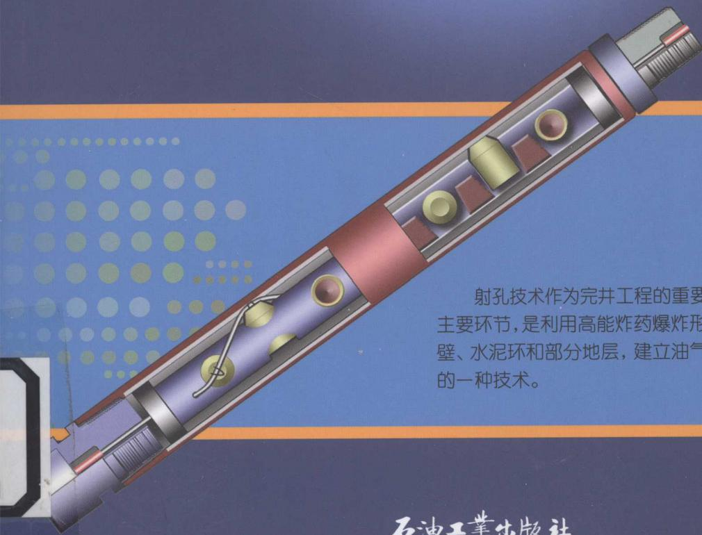
射孔技术作为完井工程的重要组成部分和试油技术的主要环节，是利用高能炸药爆炸形成射流射穿油气井的管壁、水泥环和部分地层，建立油气层和井筒之间油气通道的一种技术。
