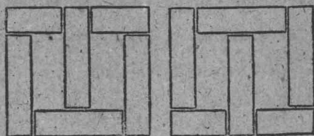
圖 14-3. 矽鋼片的重疊裝配法
