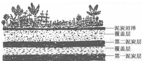
图1-4 泥炭层被覆盖后的情形示意图
